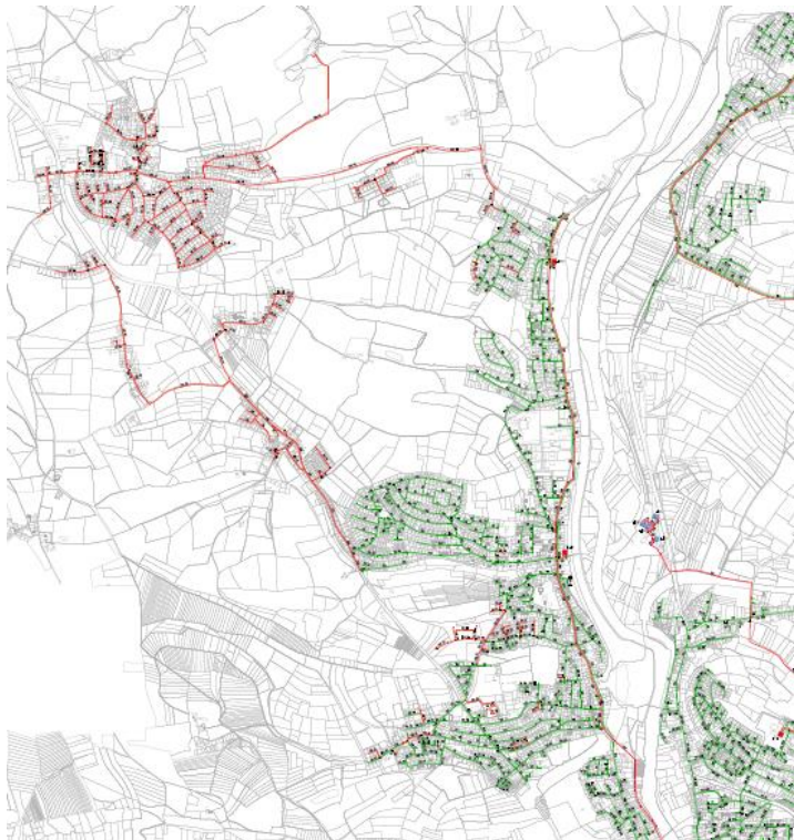
Abbildung 8 Gasnetz und Anschlüsse des Marktes Lappersdorf 9
